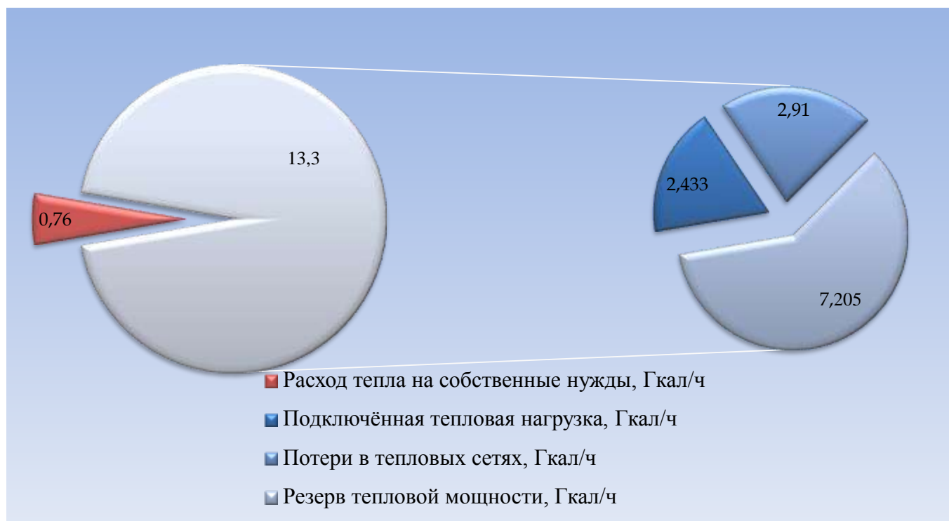
Рисунок 1.6.1.1 Тепловой баланс центральной котельной
