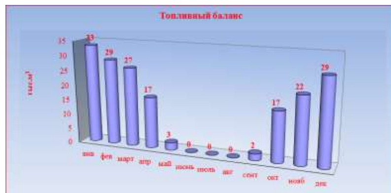
Рисунок 8.2.1 Перспективный расход топлива для школьной котельной
