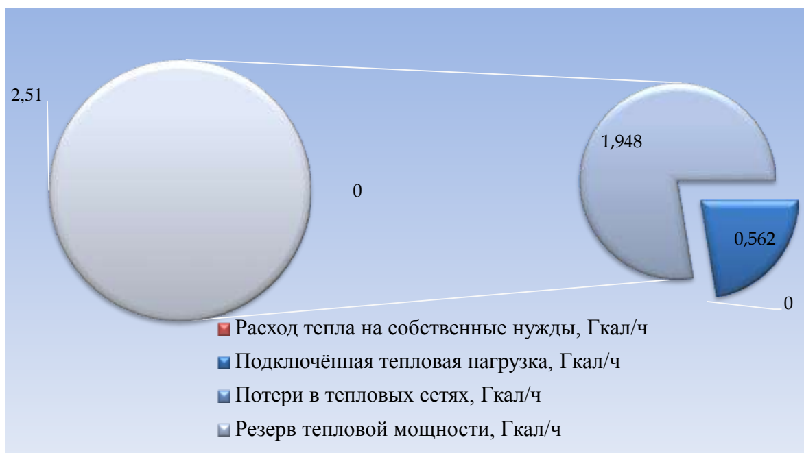
Рисунок 1.6.2.1 Тепловой баланс школьной котельной
